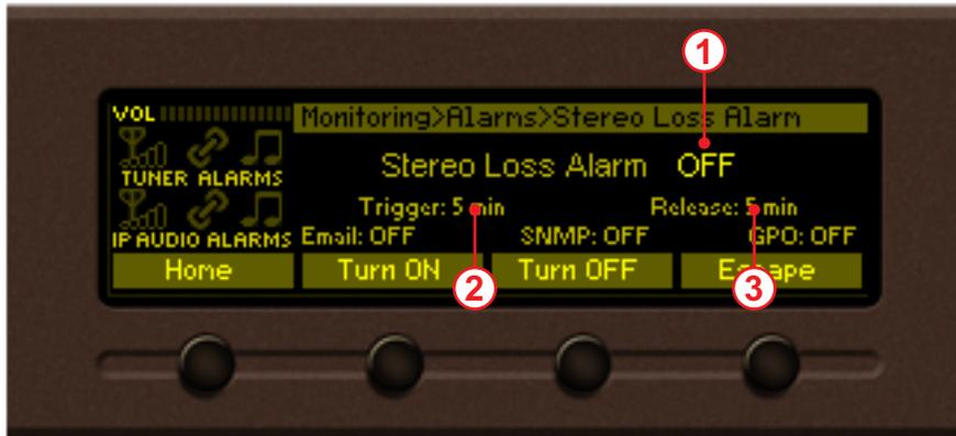
Выше показана структура диалогового окна для следующих сигналов тревоги: **Stereo Loss Alarm**, **IP Link Alarm**, **Internet Stream Alarm**. Основными элементами диалогового окна редактора сигналов тревоги являются:
