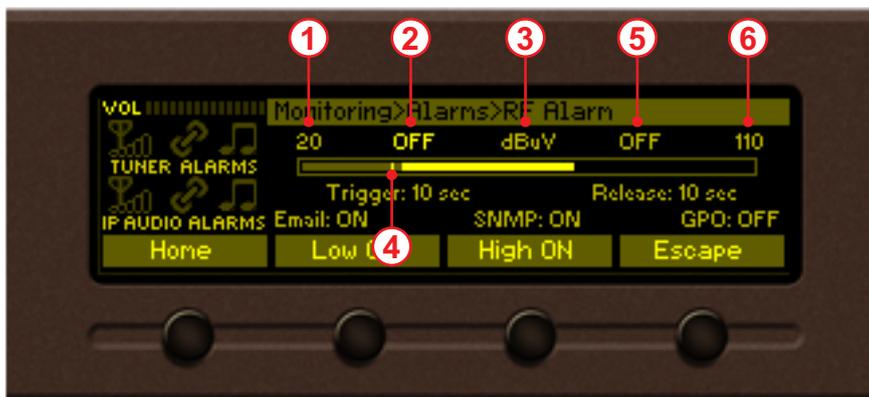
Выше показана структура диалогового окна для следующих сигналов тревоги: **RF Alarm**, **FM Left Alarm**, **FM Right Alarm**, **IP Left Alarm**, **IP Right Alarm**. Гистограмма показывает диапазон сигнала тревоги. Выделенная область представляет собой допустимый диапазон значений сигнала. Если текущее значение сигнала (поз. 4) находится в этом диапазоне,
