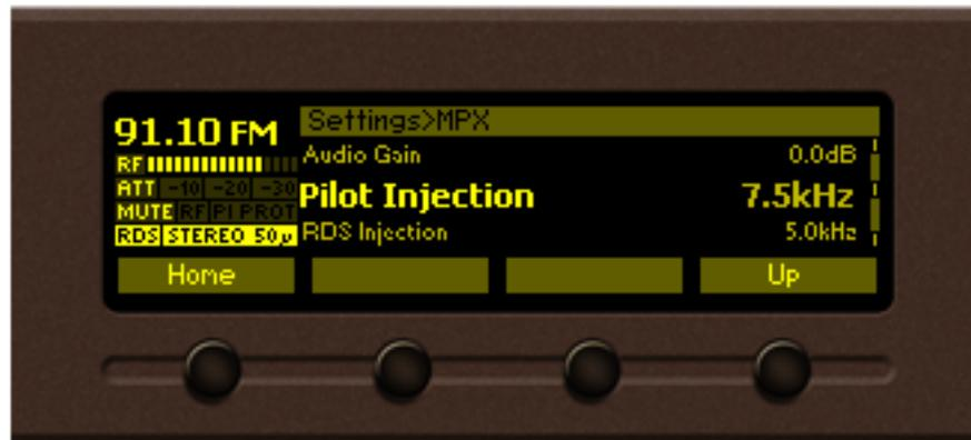
El DB7007 tiene incorporado un generador estéreo y un codificador de sistemas de datos de radio (RDS/RBDS). La cantidad de cada señal contenida en la señal MPX final se denomina nivel de inyección.
