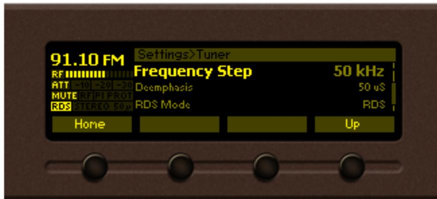
Estas configuraciones proporcionan todos los ajustes necesarios para el algoritmo que el DB7007 procesa la señal. A partir de aquí los ajustes aplicados al *Frequency Step*, *De-emphasis*, *RDS Mode*, *Audio Processing* y *Average* y *Peak* (utilizado para fijar los tiempos de respuesta de los indicadores) podría aplicarse.
