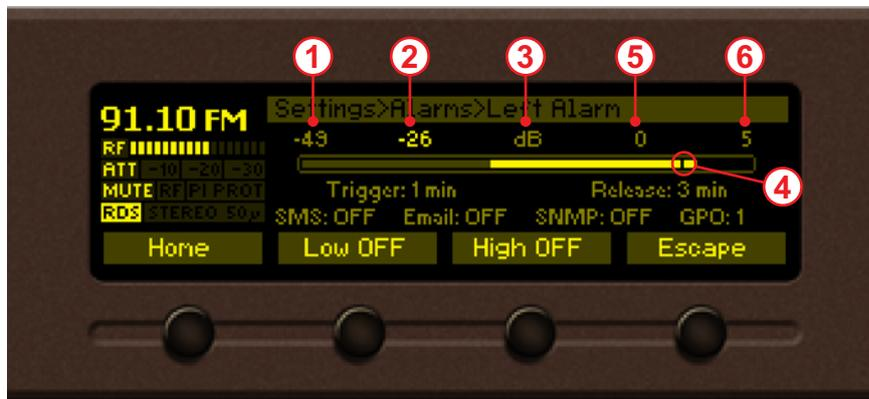
Arriba se muestra la estructura del diálogo del editor de alarmas para el: **RF Alarm, MPX Alarm, Pilot Alarm, RDS Alarm, Left Alarm, Right Alarm, Temperature Alarm, Fan Speed Alarm**.
