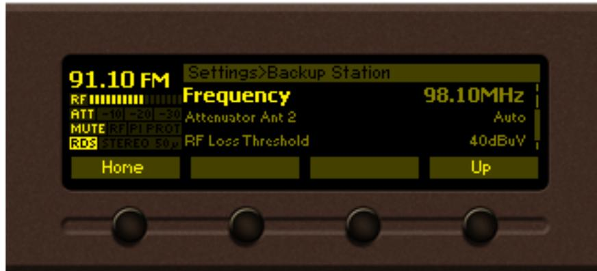
Desde aquí puede establecer los ajustes de *Frequency*, *Attenuator Ant 2*, *RF Loss* y *PI Protection* de la *Backup Station*.
