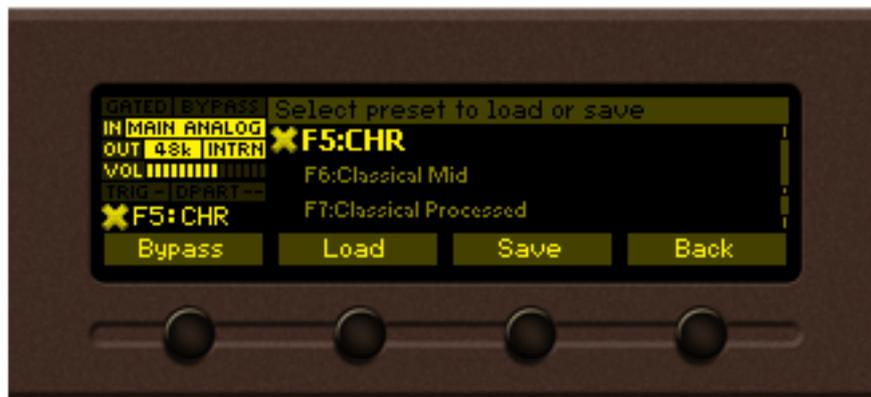
4. Para guardar los cambios, utilizando el teclado del panel frontal, seleccione uno de los presets de usuario y pulse el botón [Save]. Aparecerá una ventana de verificación. Confirme los cambios pulsando el botón [OK]. El preset recién creado se elegirá automáticamente como “preset activo”.
