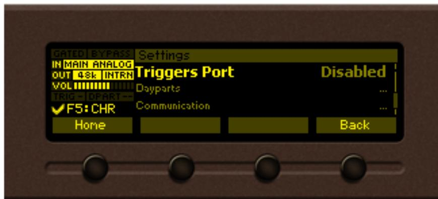
Si está activado, el puerto de activación remota le permitirá seleccionar cualquiera de los 7 primeros presets de usuario tirando de uno de los 7 pines de la toma del puerto de activación. Si se dispara más de un pin al mismo tiempo, el pin con el número más bajo será el de mayor prioridad. Por ejemplo, si todos los pines se activan a nivel bajo, el activador 1 será el de mayor prioridad.
